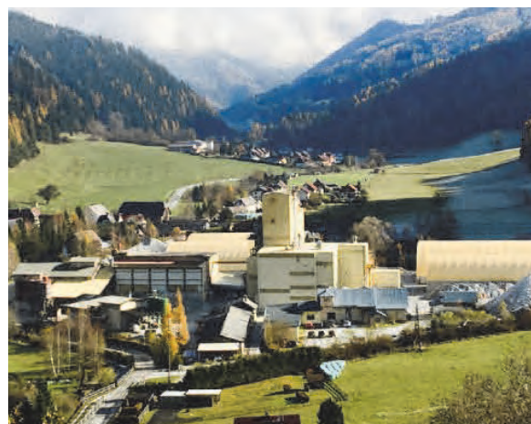
Styromag ist ein inhabergeführtes, steirisches Rohstoffunternehmen mit Sitz in Oberdorf (Tragöß-St. Katharein), das Magnesit abbaut und verarbeitet. Es produziert kaustisch gebranntes Magnesit in Wirbelschicht- und Etagenöfen.
