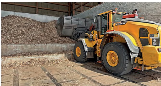
Einmal pro Schicht müssen die riesigen Schubböden mit Brennmaterial befüllt werden. Der Tagesbedarf liegt bei rund 1800 Srm
